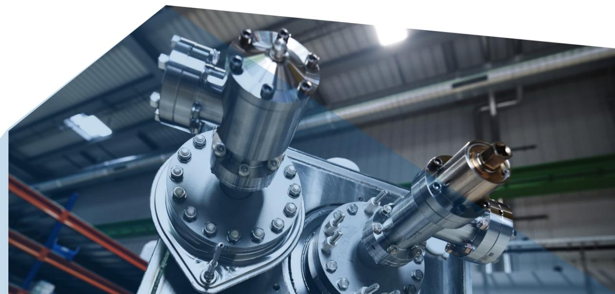
**La cavité-crabe DQW (double cavité quart d'onde), technologie novatrice du LHC à haute luminosité (HL-LHC), a été conçue pour faire pivoter les paquets en collision, permettant ainsi de décupler les collisions au LHC (Image : CERN)**
