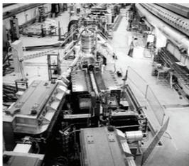
*Mise en service des Anneaux de stockage à intersections (ISR). Premier collisionneur de hadrons, les ISR marquent la transition entre les expériences à faisceaux projetés sur cible fixe et celles basées sur des collisions entre faisceaux.*
