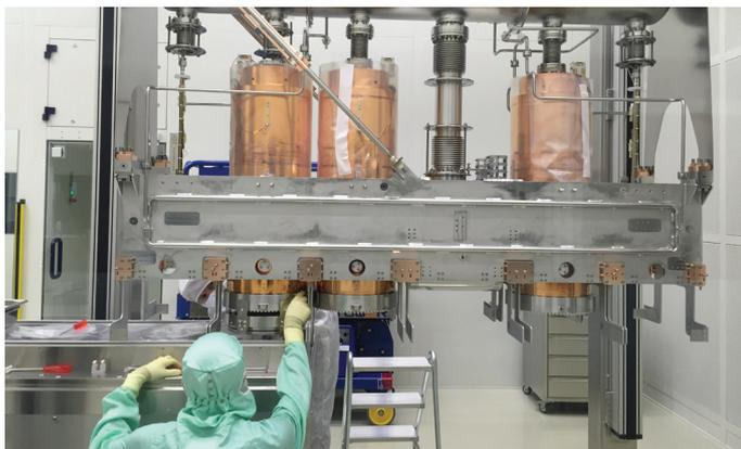
L'assemblage des premières cavités supraconductrices de HIE-ISOLDE a commencé dans une toute nouvelle salle blanche. (OPEN-PHO-ACCEL-2015 – 004)
